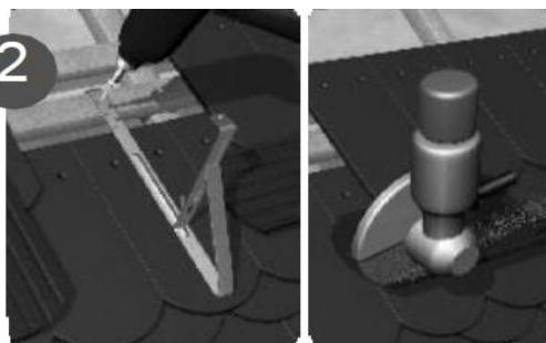
Fixati elementele suport ale sistemului de parazapada folosind 2 suruburi pentru lemn protejate impotriva coroziunii
