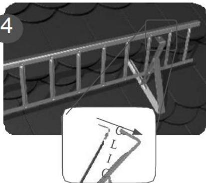
Agatati/ inserati grilajul sistemului de parazapada de elementele suport deja montate
