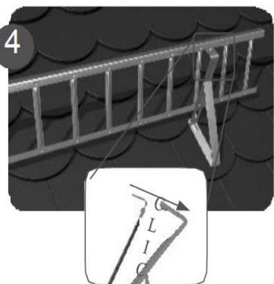
Agatati/ inserati grilajul sistemului de parazapada de elementele suport deja montate.
